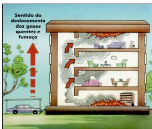
Movimentação de massas gasosas transporta o calor para cima e horizontalmente nos andares.
