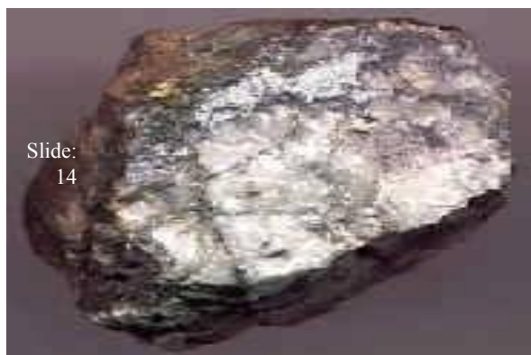
Antimônio usados na fabricação de placas para baterias, revestimento de cabos e tipos de impressão
